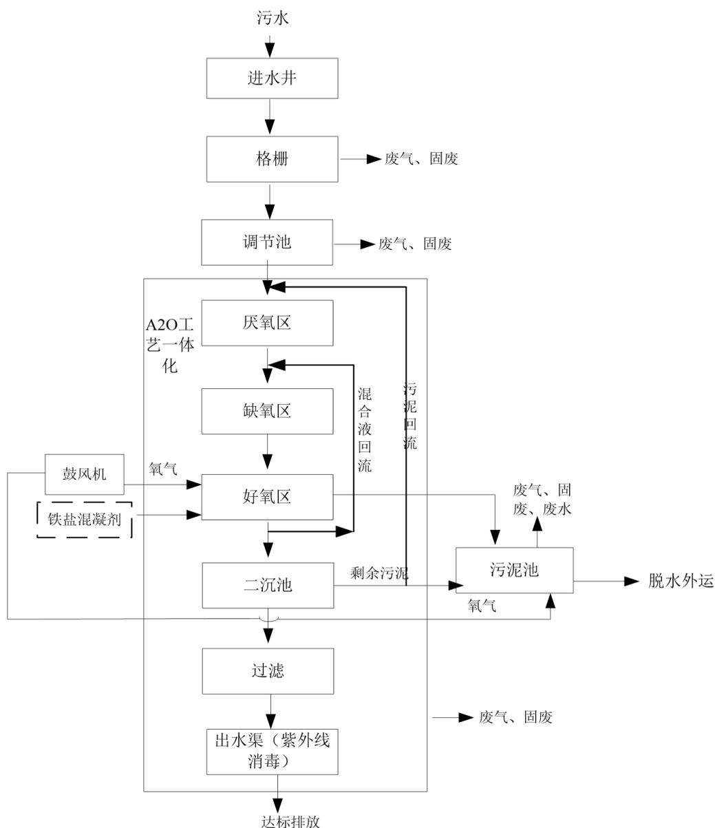
图 2.2-1 进宝塘镇污水处理厂工艺流程及产污环节图
