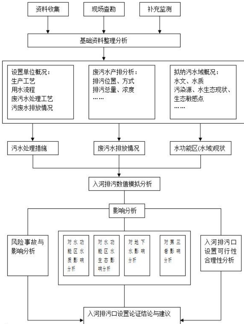
图 1.5-1 文富市镇污水处理厂排污口分析工作程序
