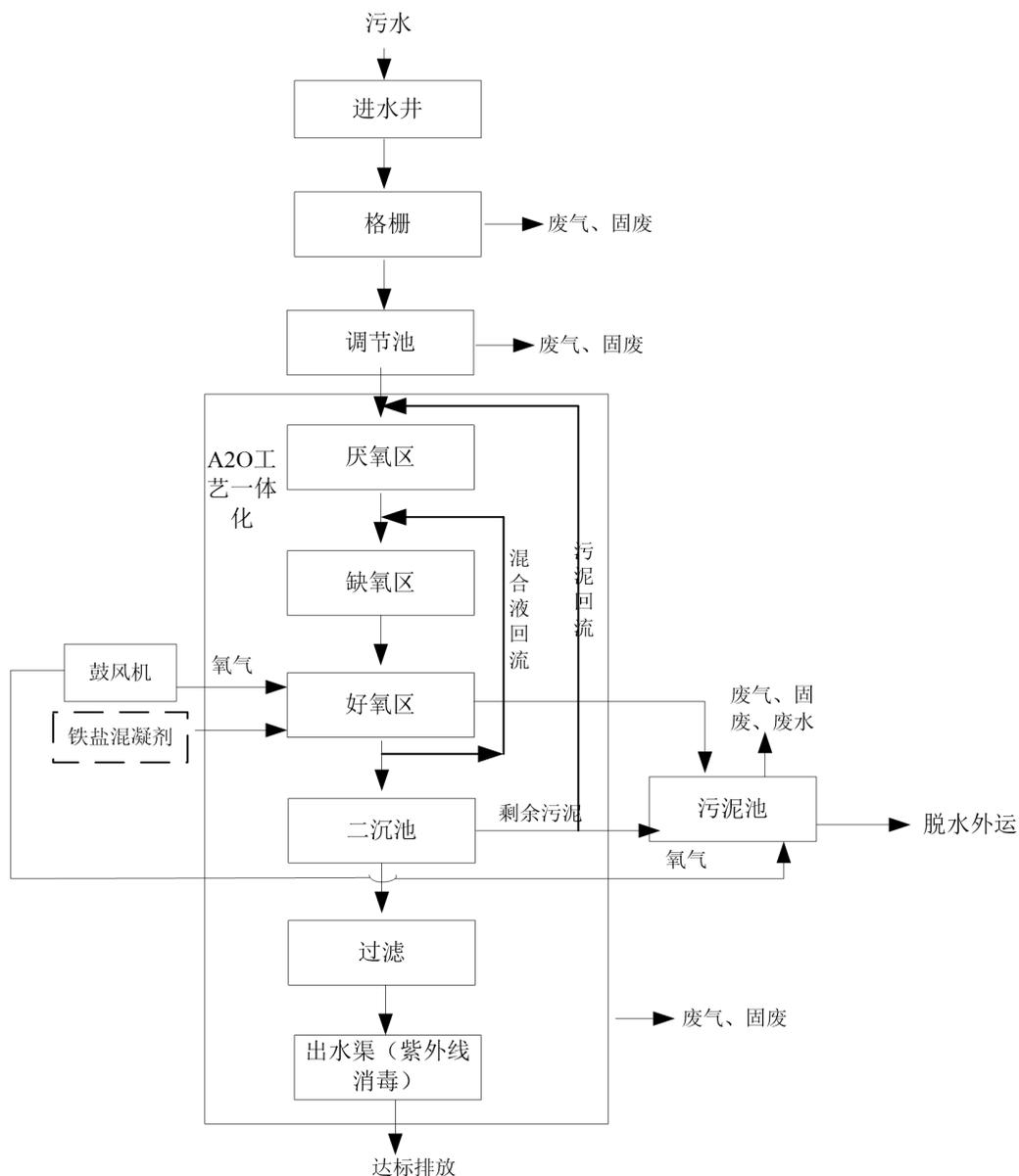
图 2.2-1 文富市污水处理厂工艺流程及产污环节图
