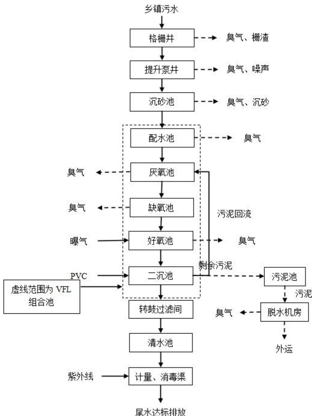
图 2.2-1 文明铺镇污水处理厂工艺流程及产污环节图
