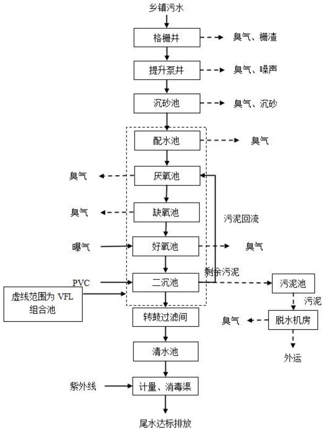
图 2.2-1 羊角塘镇污水处理厂工艺流程及产污环节图
