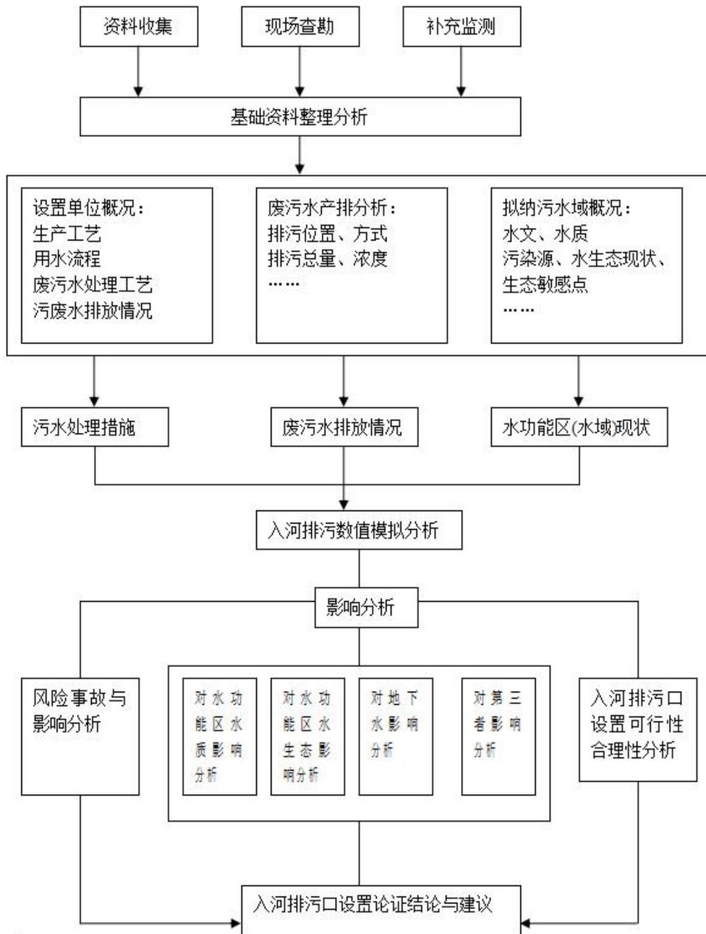
图 1.5-1 羊角塘镇污水处理厂排污口分析工作程序
